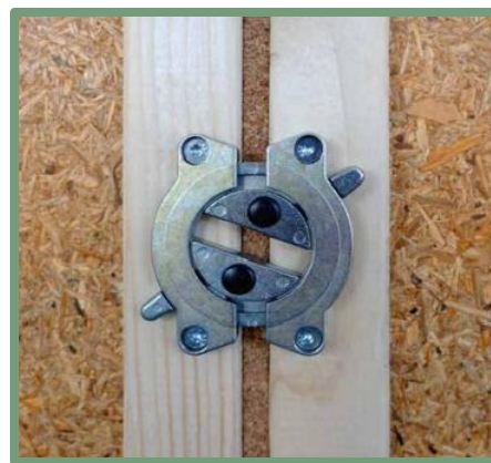
Ekspimentell sammenkobling av innvegg moduler. Kilde: CINARK
