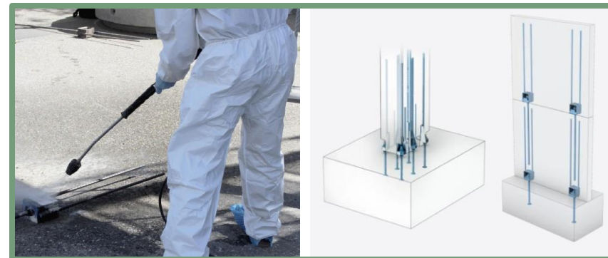
Betongelementer med koblinger som støpes inn med kalkmørtel som kan fjernes ved demontering Kilde: Pekko
